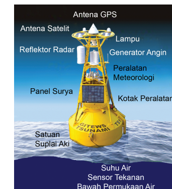
Kerangka skematis dari pelampung GPS
